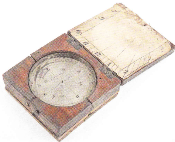
Gangloffova kapesní buzola kombinovaná se slunečními hodinami (uvnitř chybí stříelka)
